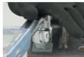
③ ロングネジナット本体をセットし、トルクレンチで規定値まで締め込みます。
