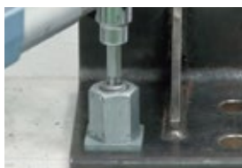
④ 止めねじをセットし、ヘキサゴンヘッドのトルクレンチで規定値まで締め込んで完了。(合いマークをつけることをおすすめします。)
