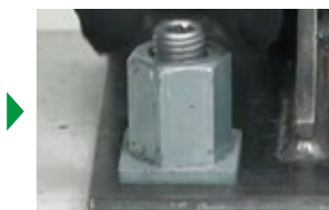
④ 止めねじをセットし、ヘキサゴンヘッドのトルクレンチで規定値まで締め込んで完了。(合いマークをつけることをおすすめします。)
